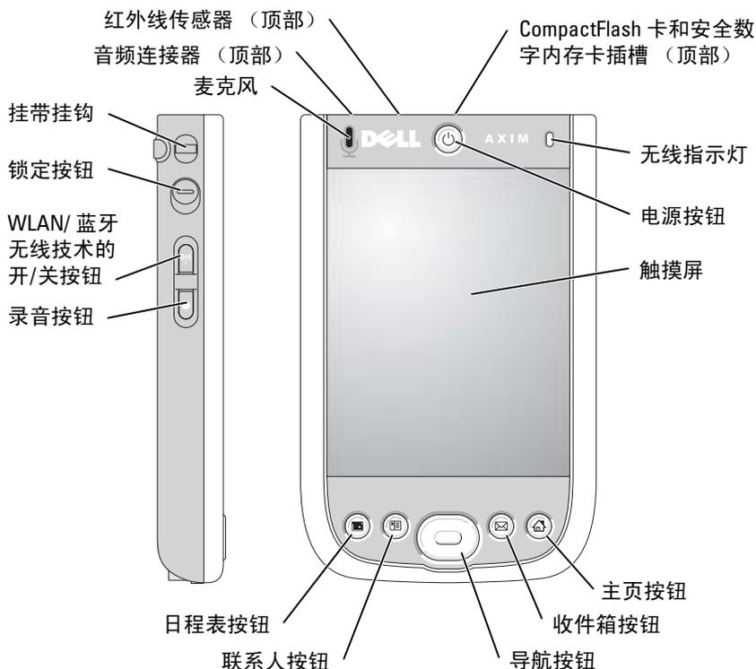
**红外线传感器** — 红外线传感器使您无需使用电缆连接，即可将文件从设备传输至另一个红外线兼容设备。
