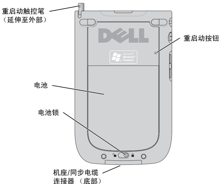
**电池锁** — 使用此开关可以松开并取出主电池。请参阅第 20 页的“安装和取出电池”。
